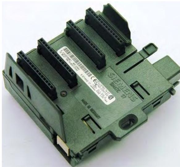
شکل ۳-۰-۳ Bus Unit برای نصب مژولهای I/O
