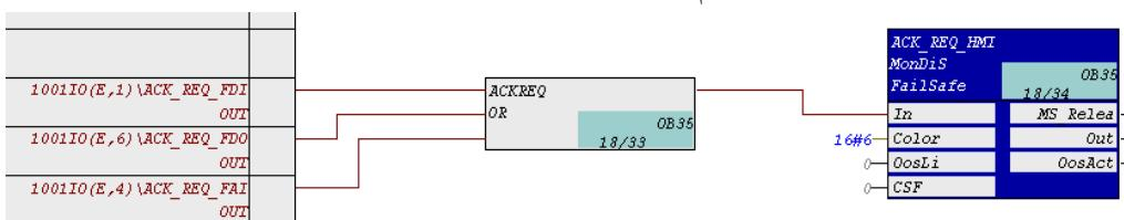
در صورت فعال شدن یک acknowledge ( $ACK\_REQ=1$ ) acknowledgment (yellow) در OS reset (6) شده و دکمه (6) در OS ظاهر می گردد.
